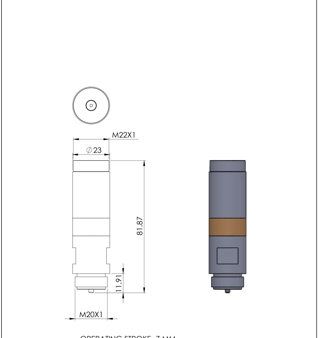
OPERATING STROKE- 7 MM MAX TANK LINE PRESSURE-240 BAR
